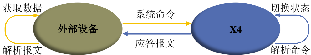
图 2 YDLIDAR X4 系统通信机制
